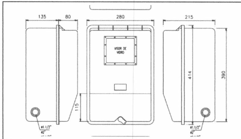
Figura 2: Desenho dimensional detalhado da caixa de medição.
